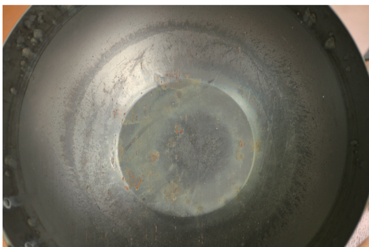
7. 内面の腐食状況を確認
