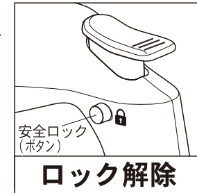
鍵がかかったイラスト側のボタンが飛び出ている。
