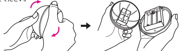
②単3形乾電池3本を本体の (+) (-) 表示に従いセットし、本体フチにある凹凸を合わせて電池カバーをはめ、本体を台に戻してください。
