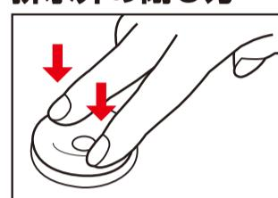
排水弁の反り返った外周部分を押すと、排水弁が閉じます。
