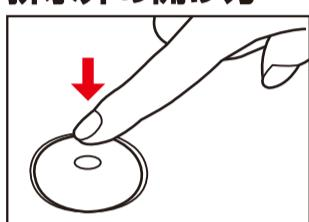
排水弁の中央を押すと排水弁が反り返って排水します。
